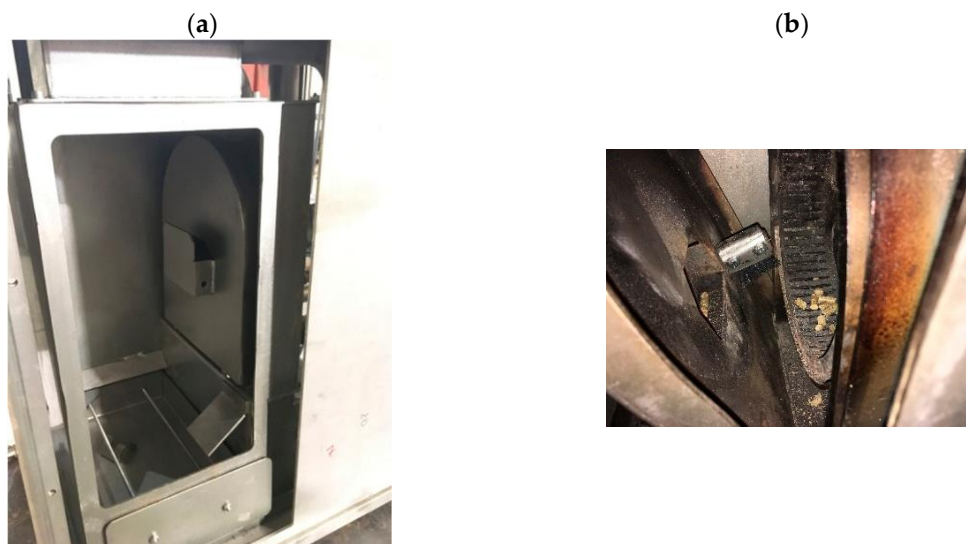
Figure 5. Unidad de incineración: cámara de combustión (a) y parrilla giratoria y cepillo de limpieza (b).
